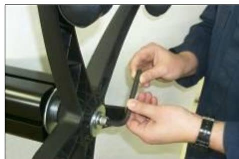
**Fase 6:** Con la chiave inglese (C-003332) (fornita), infilare il gruppo rondella e vite dentro la base del Deflussore, fino a quando la rondella sarà arrivata ad aderire contro la superficie della barra.
