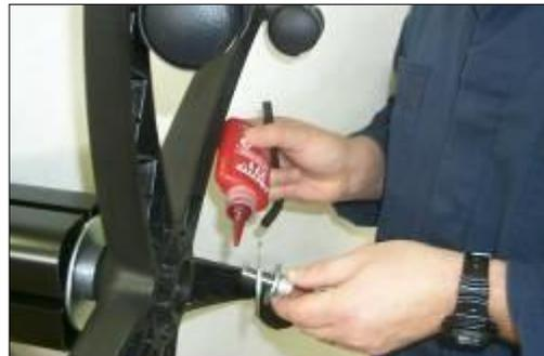
**Fase 5:** Posizionare la rondella più piccola (C-003296) dentro la vite (C-003300) seguita dalla rondella più grande (C-003295). Applicare la Loctite 242 (fornita) alla filettatura della vite (C-001523), come nell'illustrazione.
